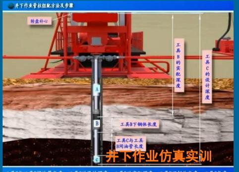
工具C与工具B同油管长度—工具C的设计深度—工具B的实配深度—工具B下纲体长度—工具C长度。
